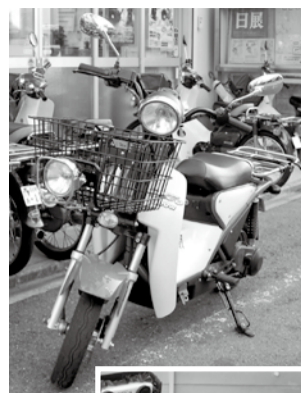
バッテリーに専用コードとインバーター(変換機)を装着し、家庭用の電気をポットを接続した電動バイク
