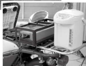
バッテリーに専用コードとインバーター(変換機)を装着し、家庭用の電気をポットを接続した電動バイク
