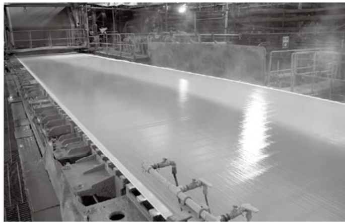
再生された段ボールの「中芯」用の原紙。繊維を含んだ溶液が吹き付けられる工程
