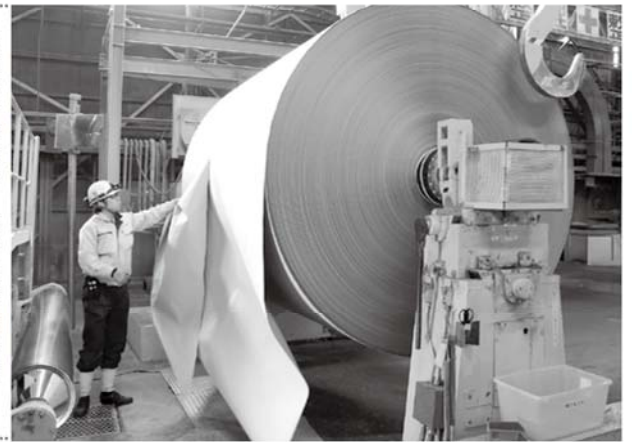
再生された段ボールの「中芯」用の原紙。繊維を含んだ溶液が吹き付けられる工程
