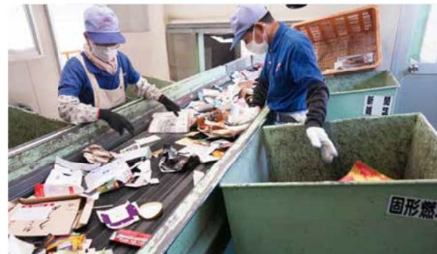
ベルトコンベヤーで運ばれたものを再び人の手で選別。「固体燃料になる容器包装や、古紙などをより分けます。
