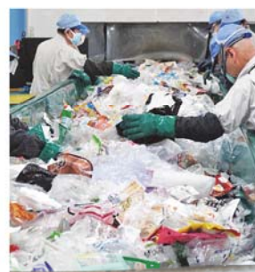
プラスチック製容器包装から手選別で不適合物などを取り除く港区の中間処理施設
