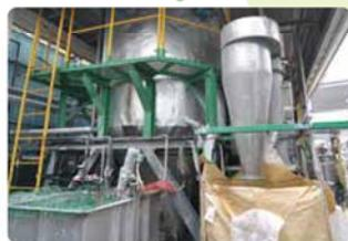
3センチ角に粉碎したペットボトルを高温のアルカリ液に浸して汚れを取り除く装置
