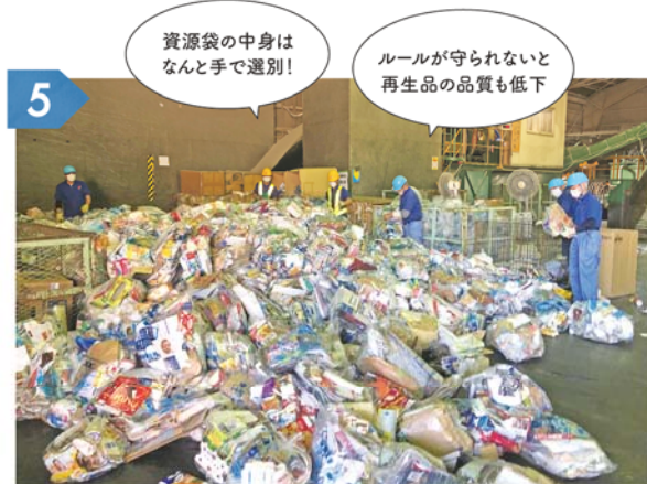
市の紙製容器包装の回収袋は回収後、「目視」や「手選別」によって分類・チェックされています。しかし「作業には限界があり、回収に出す皆さんの協力なしでは、良いリサイクルができません」と堀部さん。
