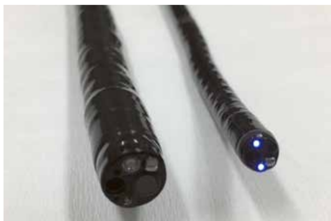
左: 通常口径口内視鏡スコープ(直径10.2mm) 右: 細径経鼻内視鏡スコープ(直径5.4mm)
